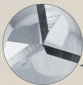
affilatura a croce con smusso di rinforzo e aumento della scanalatura dell'elica per operazioni di foratura e rampa
